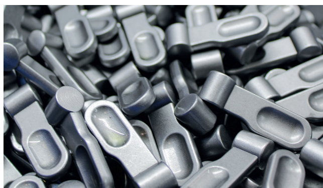
4 Aufgrund der optimierten Werkzeuggestaltung und eines ausgeklügelten Verschleißschutzes kann Kipp bis zu 4000 solcher Riegel mit nur einer Reibahle HR 500 fertigen
